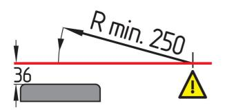
Attention! La mesure 36 mm doit se référer à la surface du boîtier et non à l'actionneur rentré!
