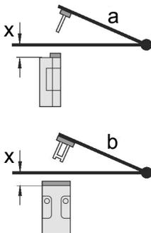
Drehpunkt des Scharniers und Oberkante des Sicherheits-schalters zuzüglich  $x$  mm müssen eine Ebene bilden.
