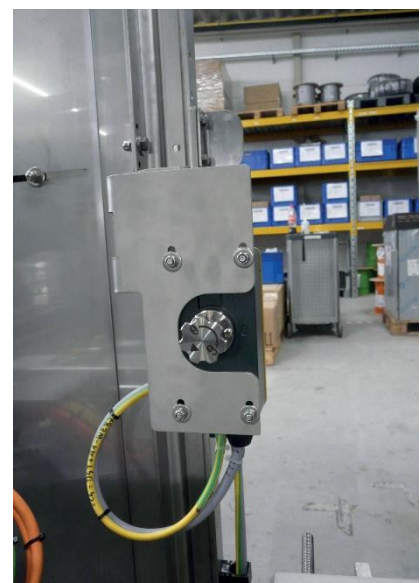
Fig. 4 Lo sblocco di fuga è un'opzione prevista per l'improbabile eventualità che il personale rimanga intrappolato nell'area di pericolo.
