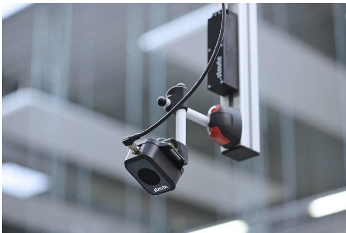
03 Visione dall'alto: i sensori a lunga portata rilevano le postazioni libere nei supermercati di materiali. Ben in vista: il modulo separato di batteria e il modulo radio.
