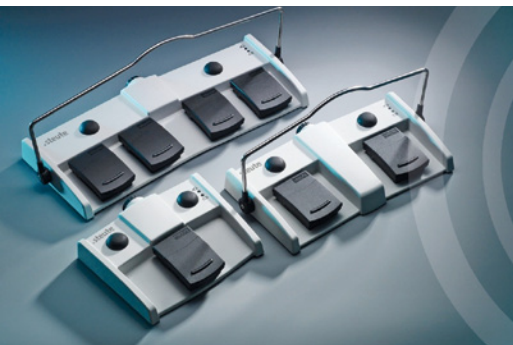
Bild 3. Die Mehrzahl der von Steute Meditec gefertigten User Interfaces kommuniziert mittlerweile per Funk mit dem zu steuernden Medizingerät. (Bild: Steute Meditec)
