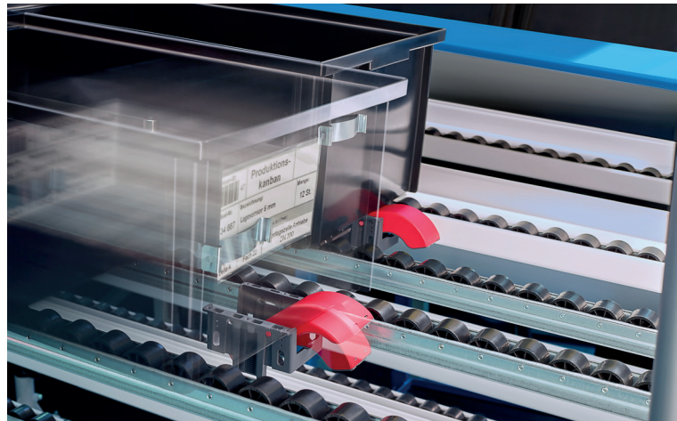
02 Funk-Sensoren detektieren Behälter zum Beispiel in eKanban-Regalen und senden die Signale über eine Sensor Bridge an die Unternehmens-IT.
