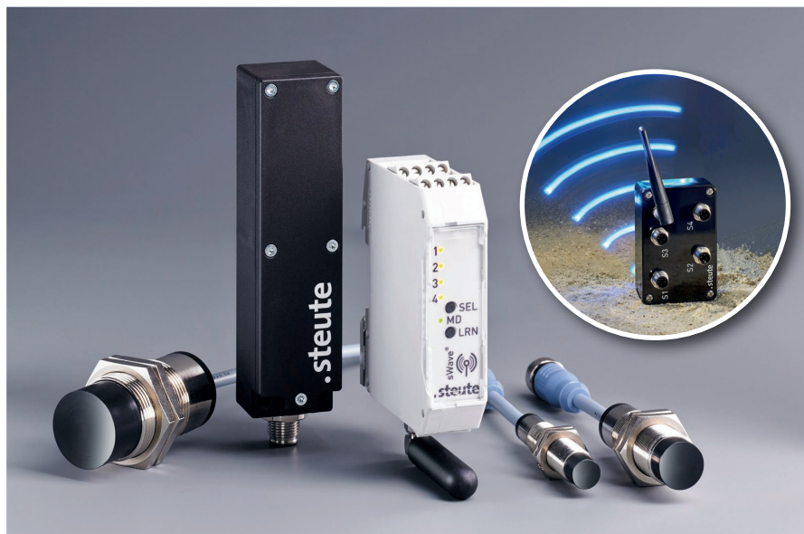
Induktivsensoren kommunizieren über ein Funkmodul (Mitte links) mit der zugehörigen Empfangseinheit (Mitte rechts) oder auch mit Gateway-Empfängern
